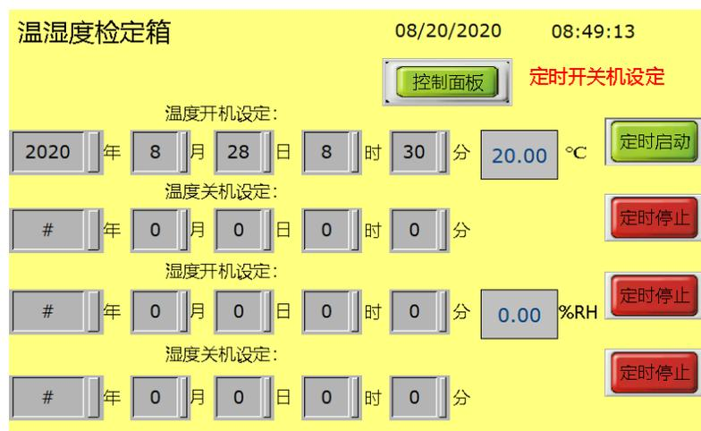
图3-13 定时开关机设定
